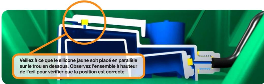
Veillez à ce que le silicone jaune soit placé en parallèle sur le trou en dessous. Observez l'ensemble à hauteur de l'œil pour vérifier que la position est correcte
