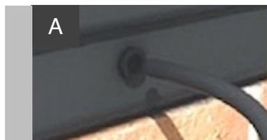
**A** Fixer la gomme sur le tank, puis introduire le tuyau 6mm
